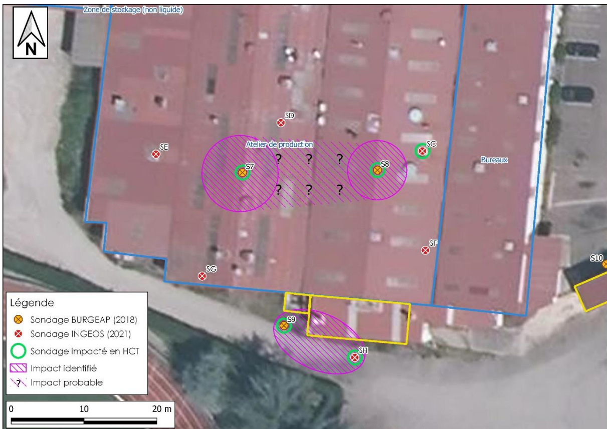
Figure 8 : Localisation et emprise approximative des impacts en hydrocarbures totaux
